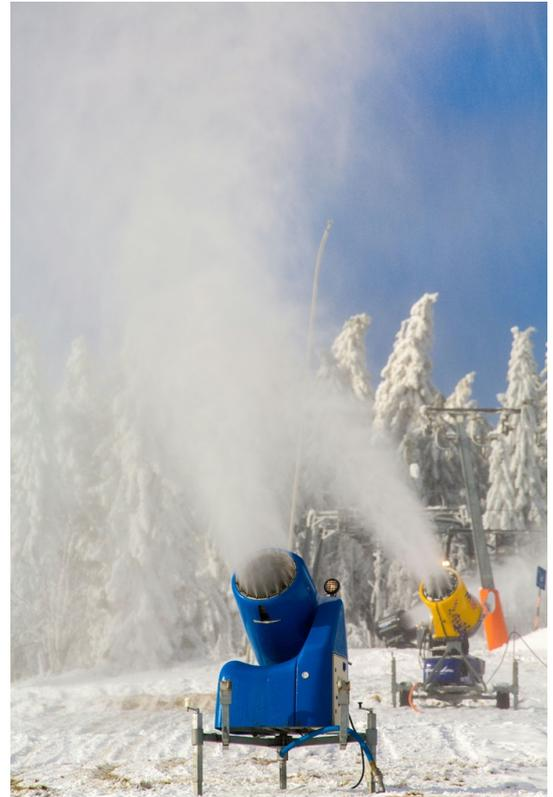
Sobald die Maschine läuft, sprühen aus einigen Düsen feine Wassertropfen. "Wenn es kalt genug ist, entstehen daraus winzig kleine Eiskörnchen", sagt Hubert Neidhardt. Durch andere Düsen wird das Wasser noch feiner zerstäubt - wie Nebel. "Diese kleinsten Tröpfchen können sich dann an die größeren Eisteilchen anlagern. So wird der Eiskristall größer", erklärt er.
